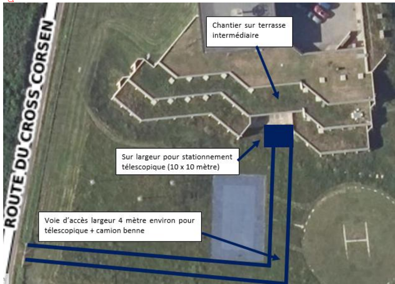
Figure n° 16 _ principe voie d'accès pour intervention sur toiture terrasse intermédiaire
